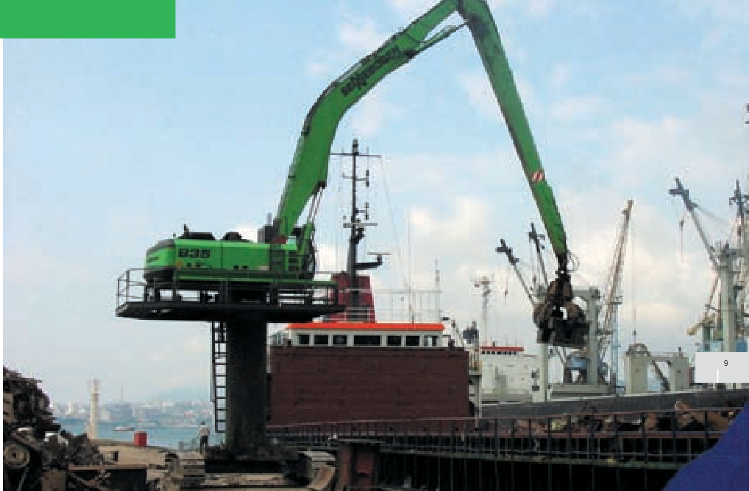
835 R special - 5 м пилон – стрела V19 – погрузка металлолома лепестковым грейфером – Россия
