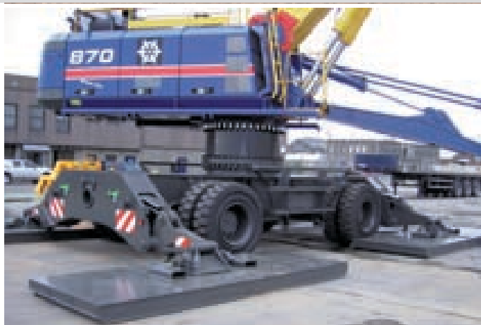
Увеличенные опорные плиты для уменьшения удельного давления на причал
