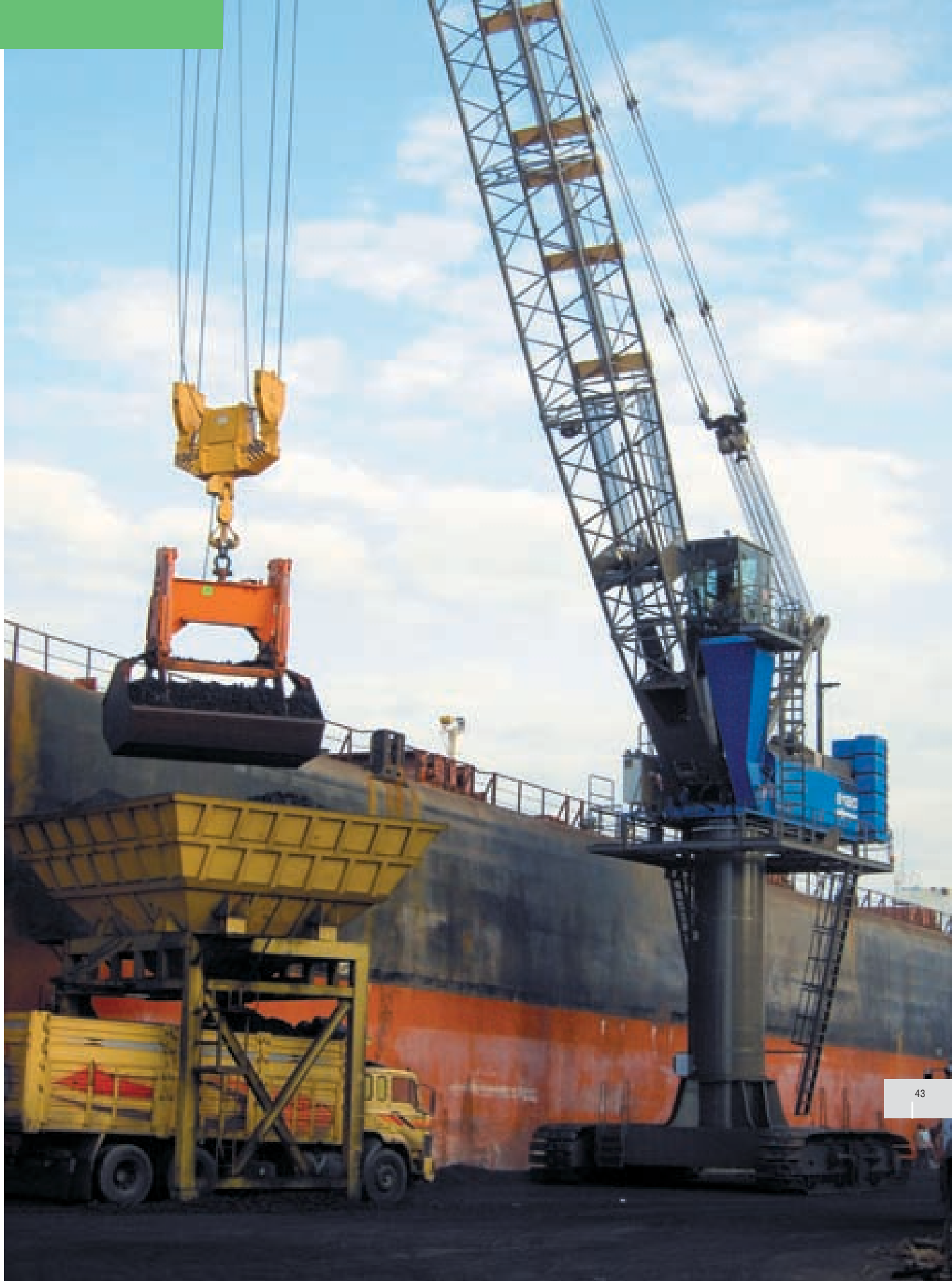
6180 HCC – пилон 8 м – стрела 33 м – выгрузка угля электро-гидравлическим грейфером 25 м 3 на поворотном кране – Турция
