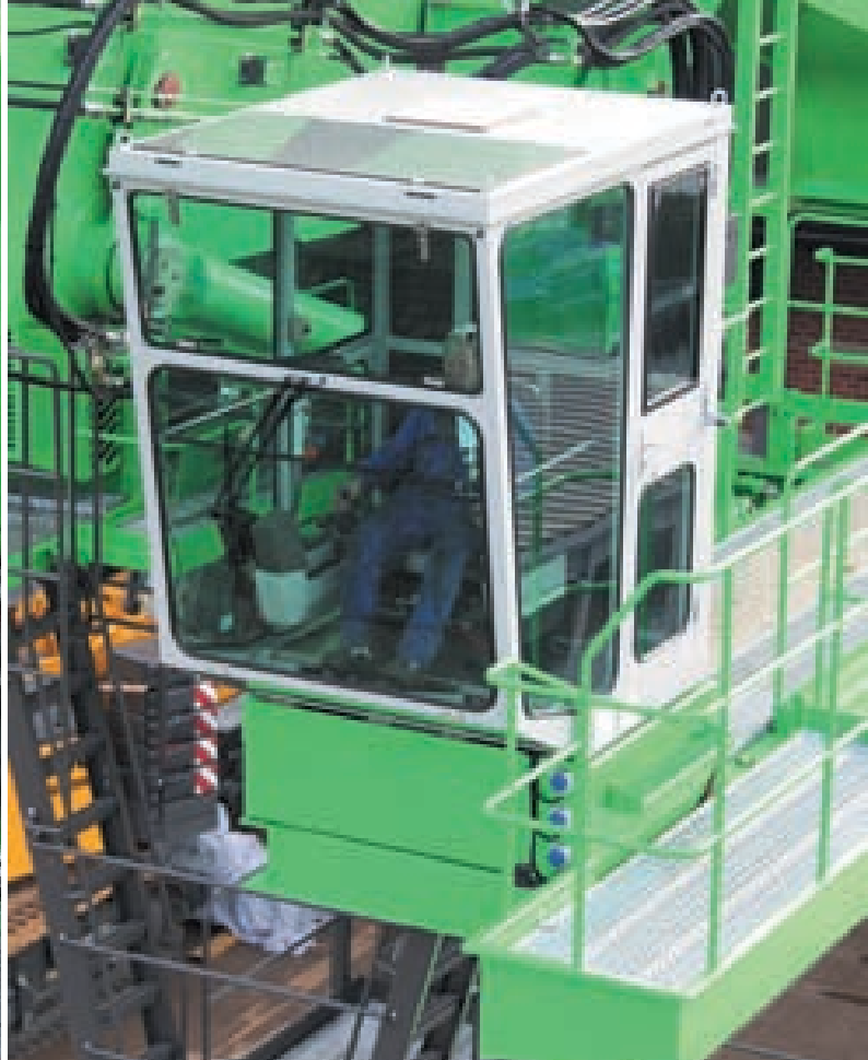
Увеличенная кабина PORT CAB с панорамным безопасным остеклением
