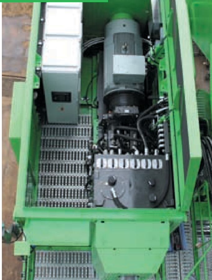
880 EQ electro – защищенное машинное отделение
