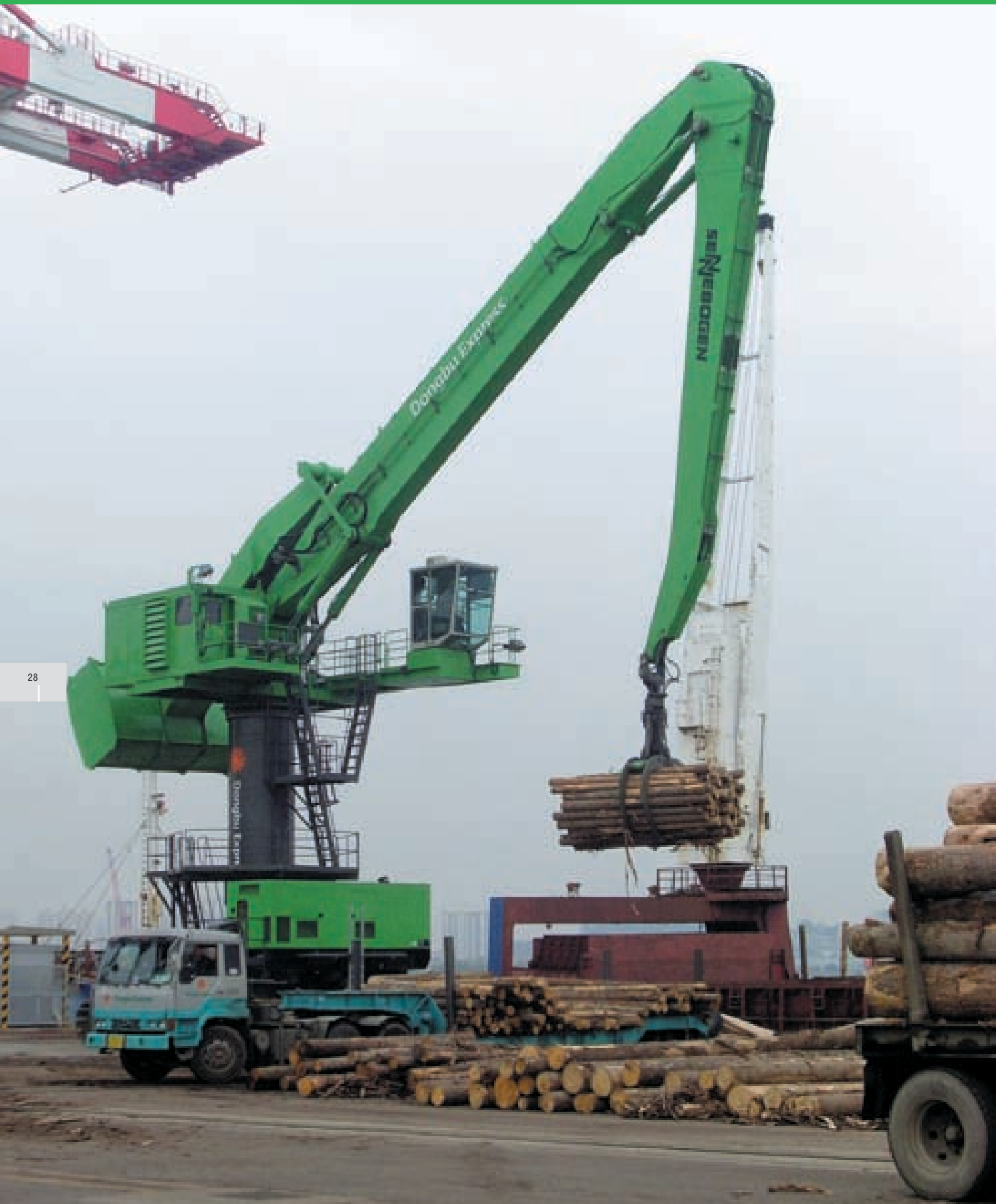
880 EQ R special electro с дополнительным дизель-электрическим приводом – стрела K33 – перевалка леса грейферным захватом для бревен сечением 2,5 м 2 – Южная Корея
