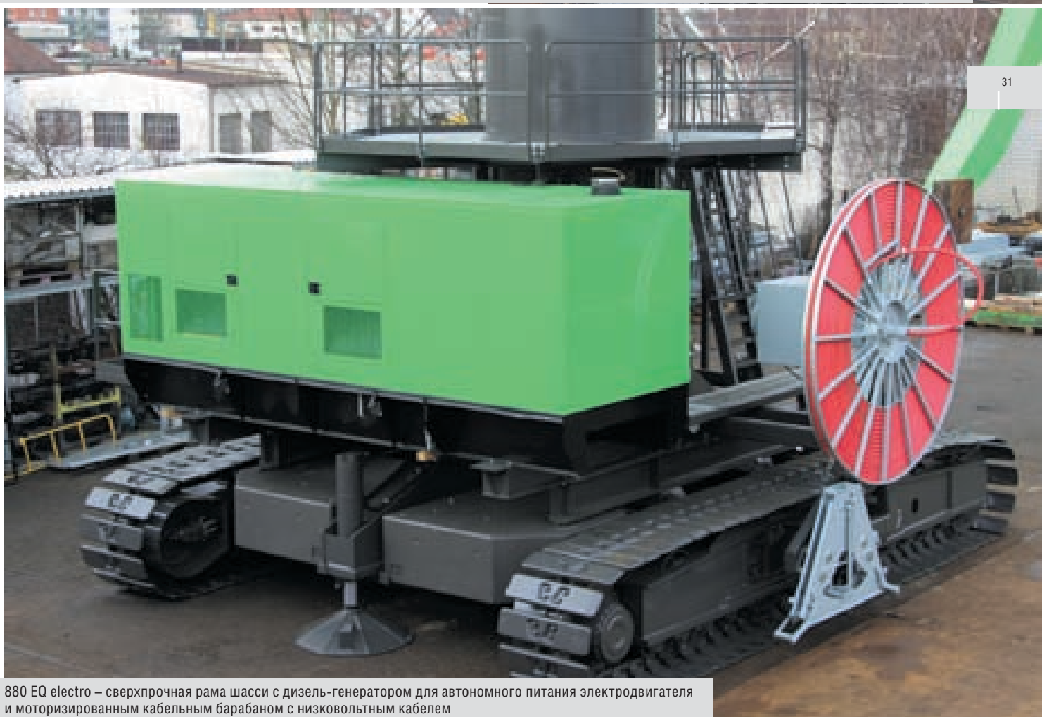
880 EQ electro – защищенное машинное отделение
