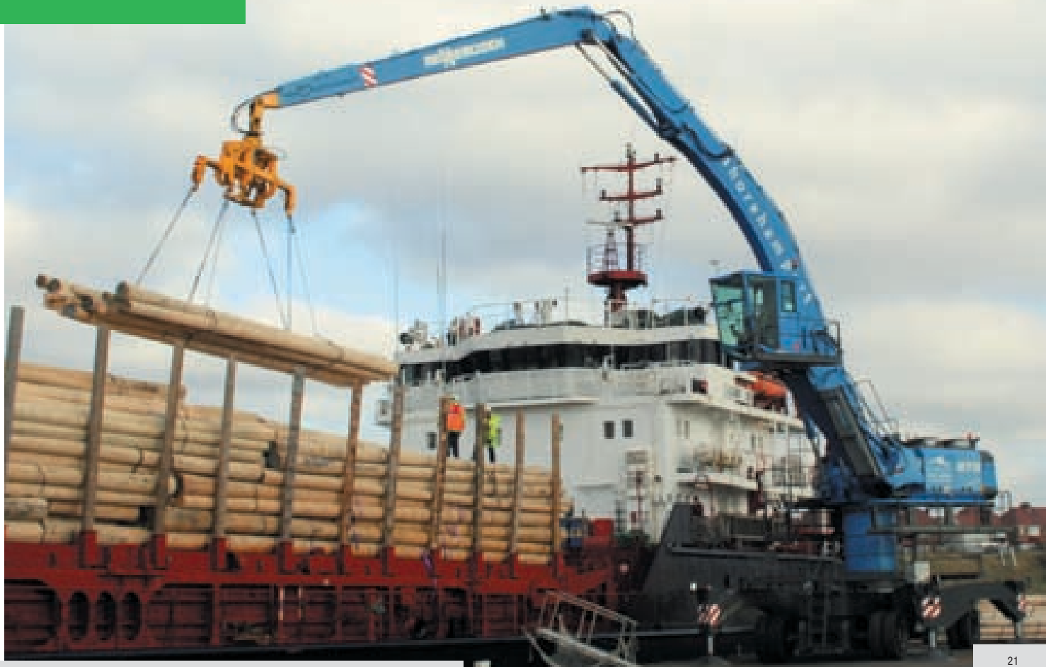
870 M special – колесное шасси DS100 – стрела B23 – перевалка леса с помощью гидравлической крюковой траверсы – Англия
