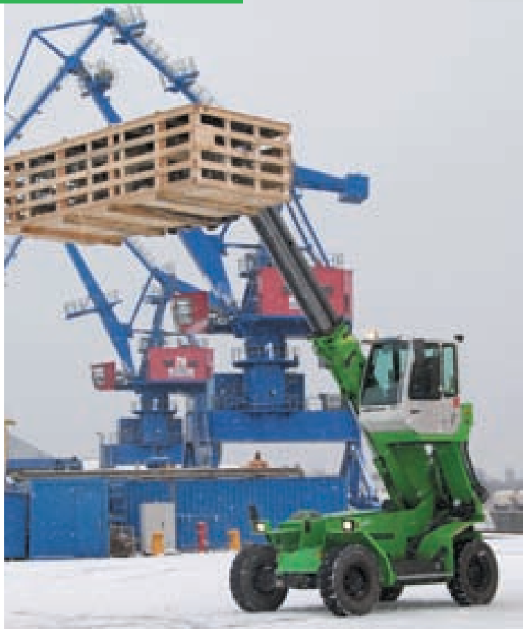
305 Multihandler – вилы для подъема тяжелых грузов на высоту до 7 м – Германия
