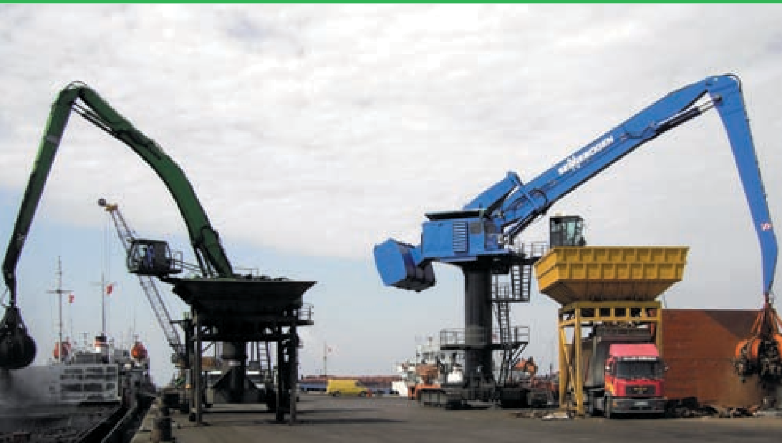
880 EQ R special – стрела К30 – перевалка металлолома лепестковым грейфером объемом 8 м 3 – Турция
