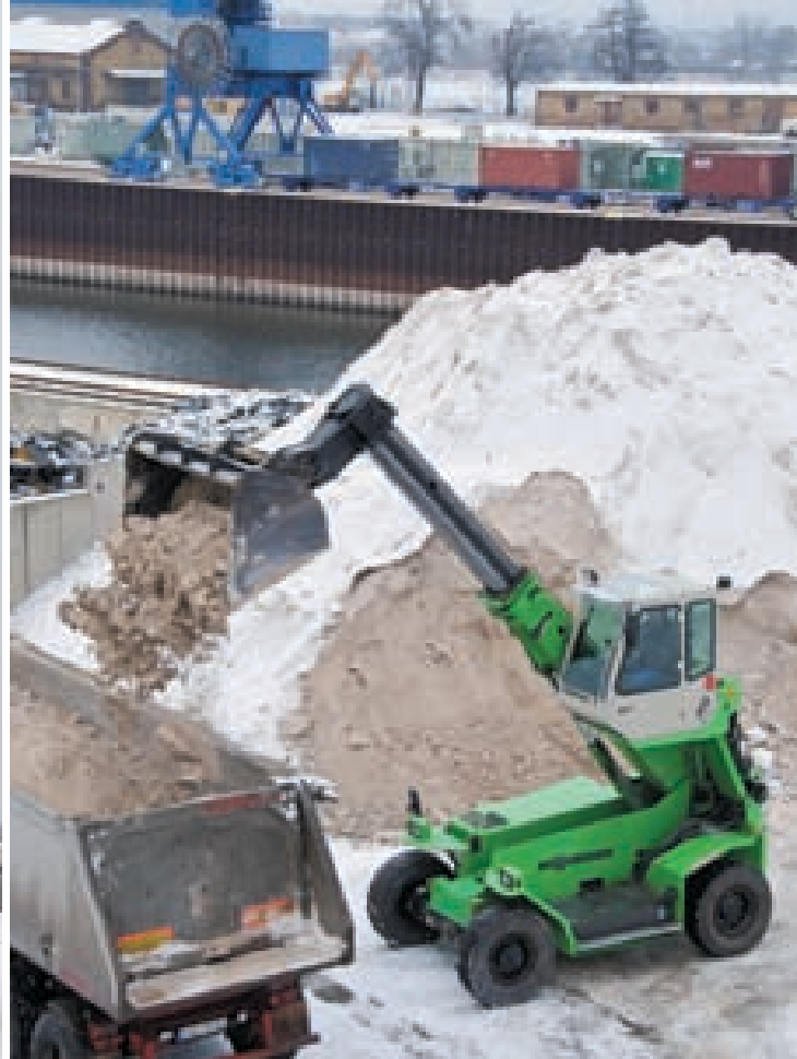
88305 Multihandler – погрузка плавикового шпата на грузовики с помощью ковша объемом 3 м 3
