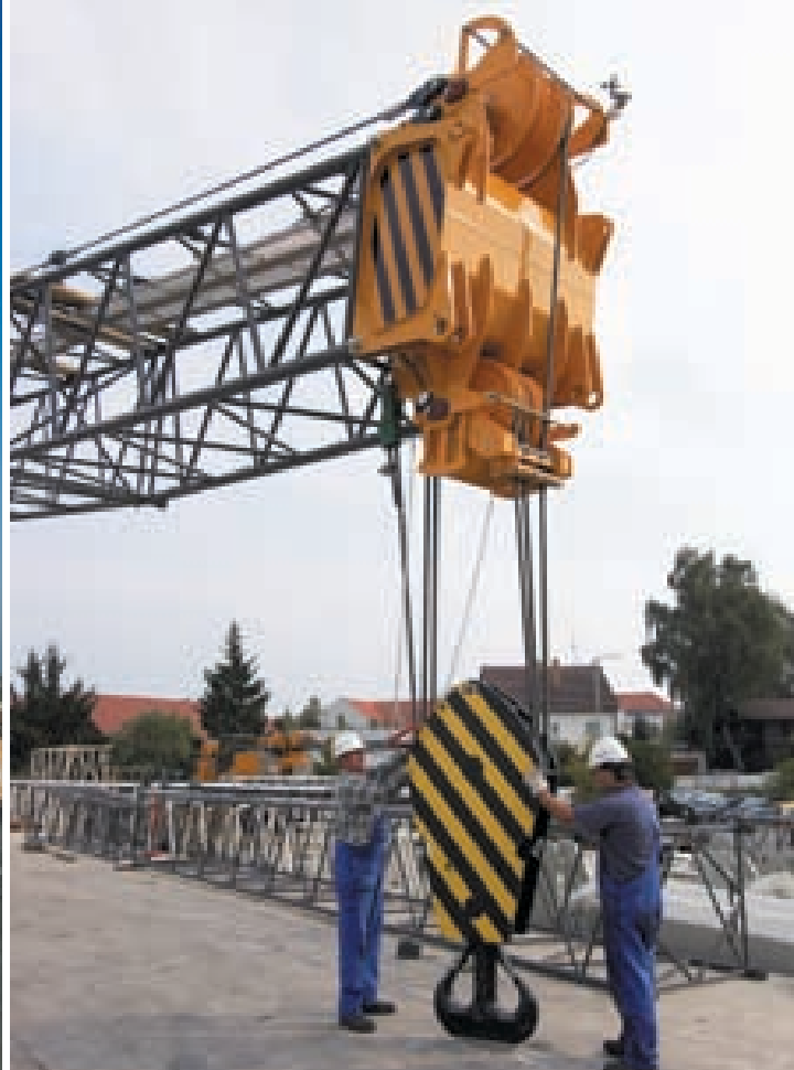
Мощный крановый двурогий крюк на оголовке стрелы
