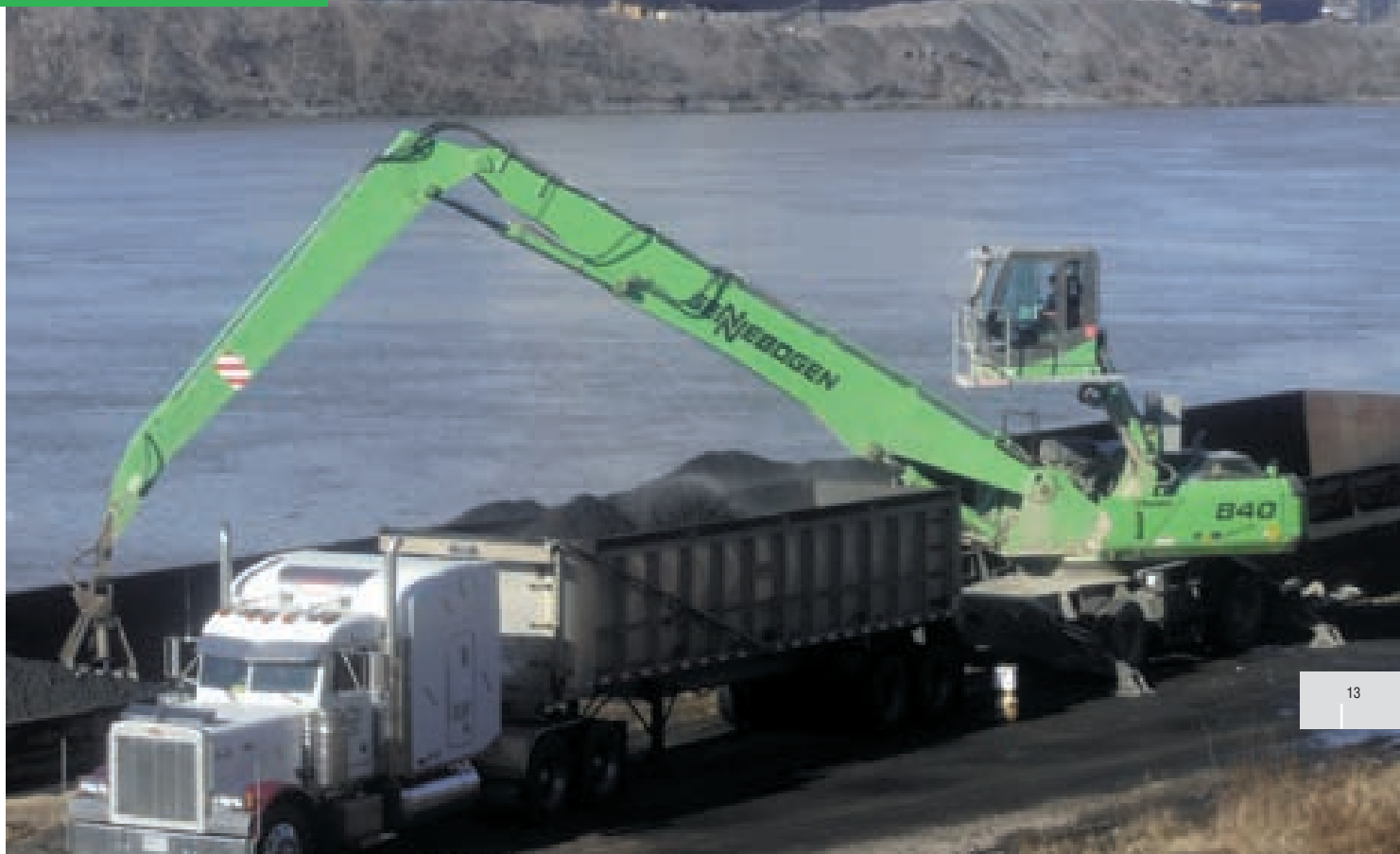
840 M – стрела K17 – перевалка угля с помощью грейфера для сыпучих грузов 3 м 3 – США
