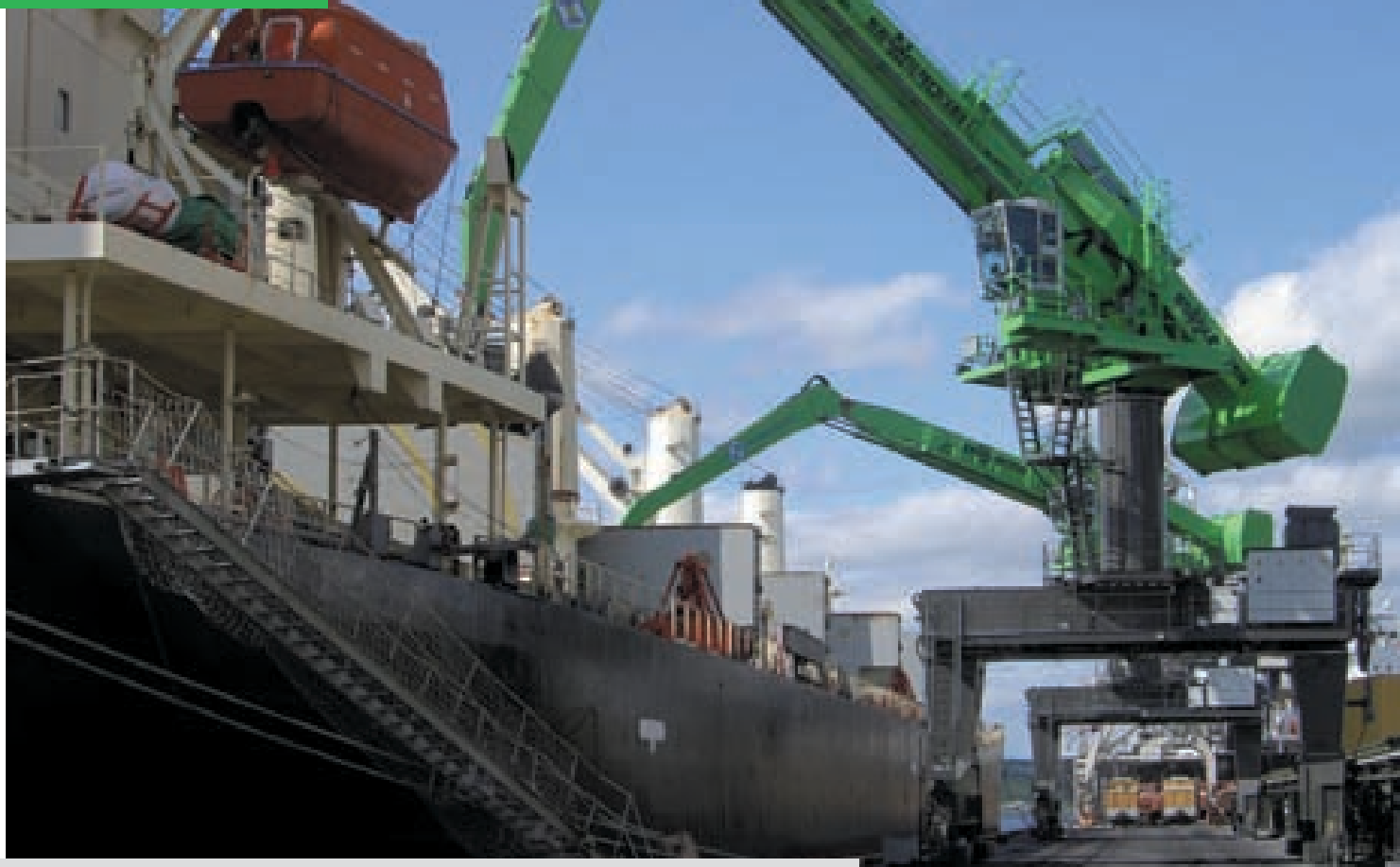
880 EQ electro – портальный рельсовый – высота портала 6 м, колея 10.5 м – стрела K30 – высота кабины над причалом 17 м – перевалка железорудного концентрата грейфером 4 м 3 – Россия
