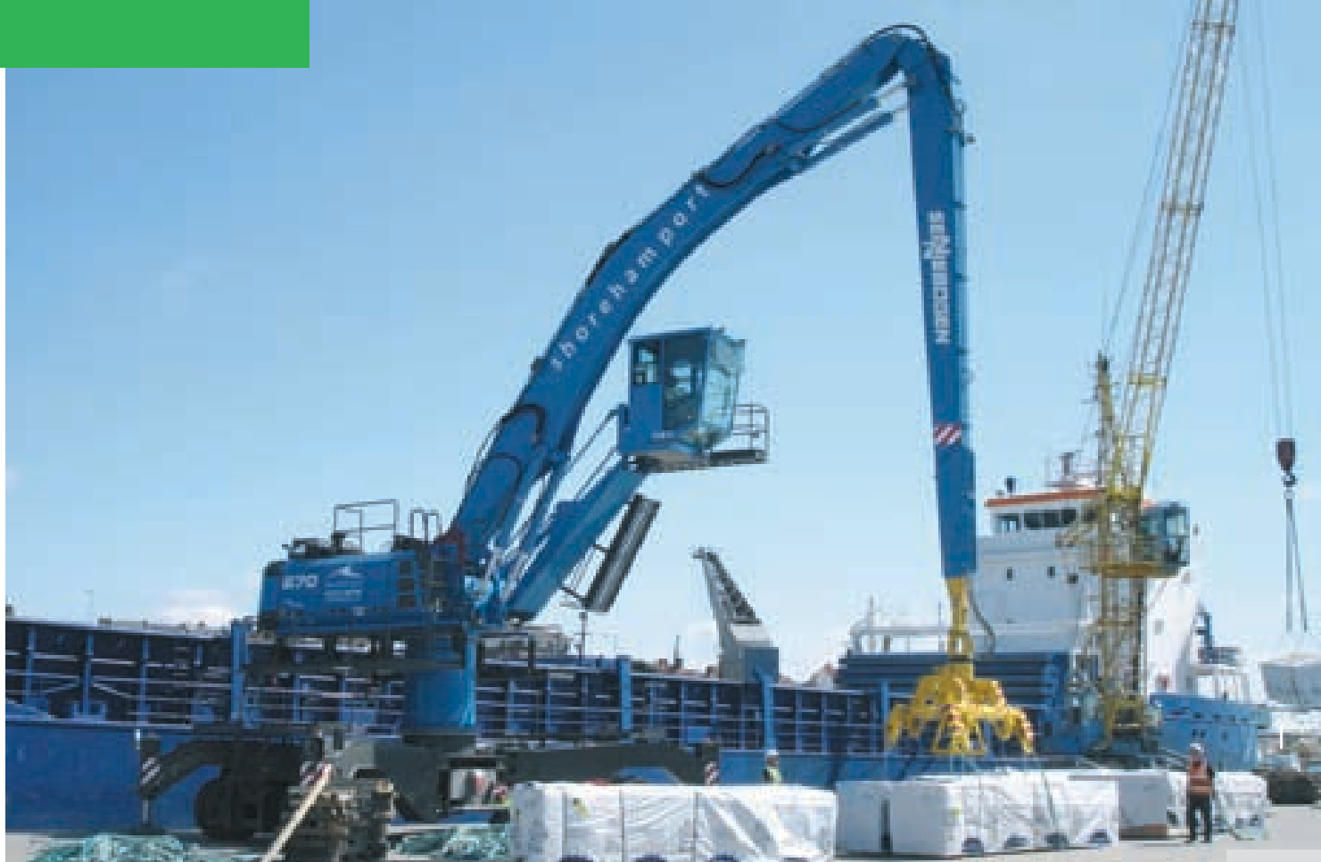
870 M special – колесное шасси DS100 – стрела B23 – перегрузка леса в пачках с помощью гидравлической крюковой траверсы – Англия
