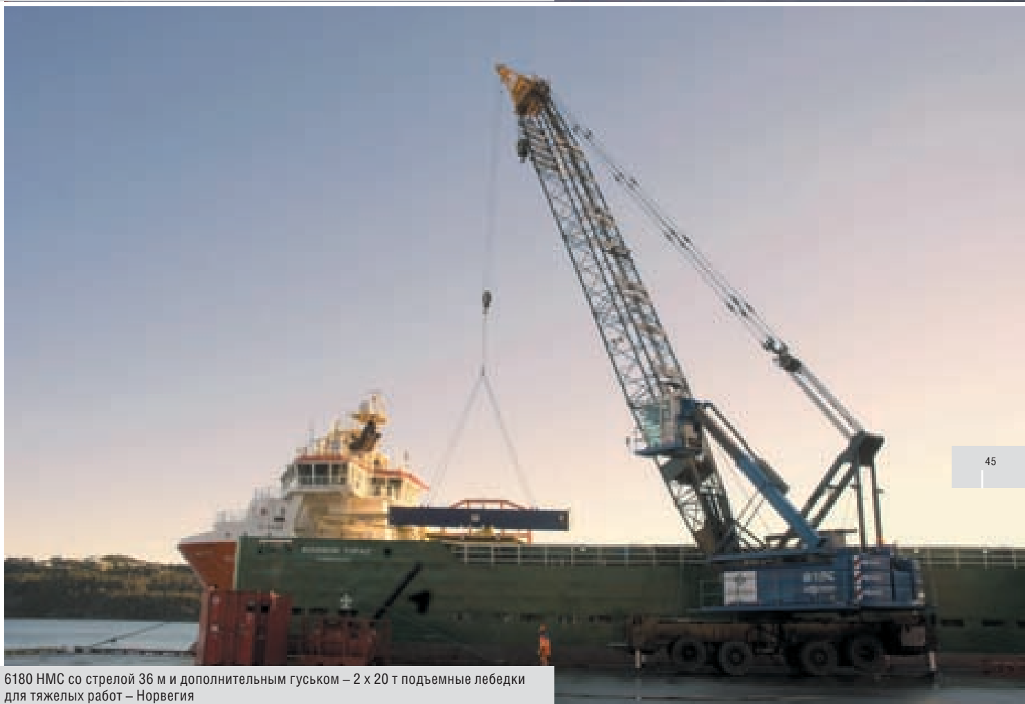
2 x 6180 HMC – телескопический подъемник кабины – стрела 36 м – 2 x 20 т крановые лебедки – Норвегия
