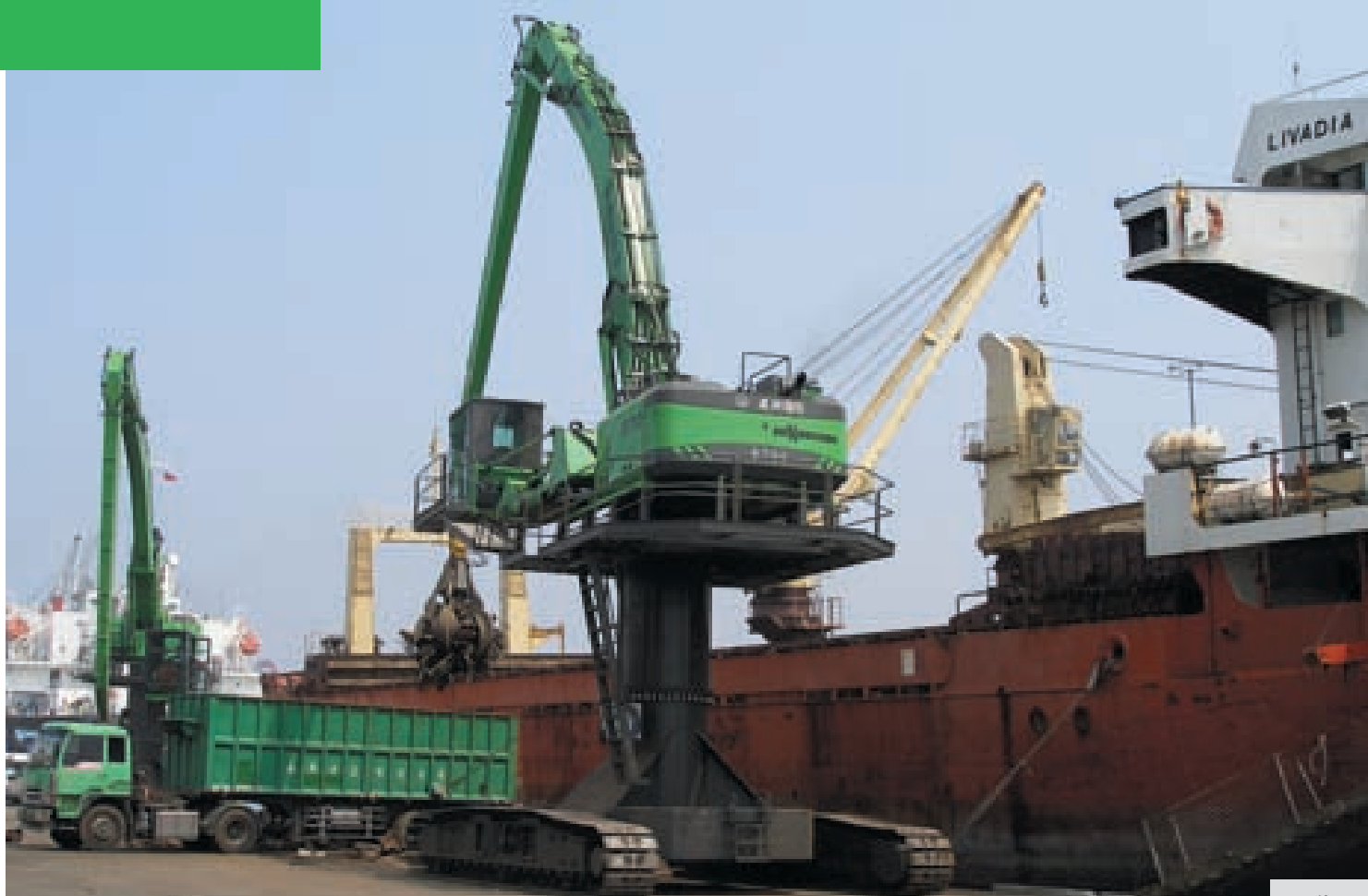
870 R special – 5 м пилон – стрела B23 – перевалка металлолома лепестковым грейфером – Тайвань
